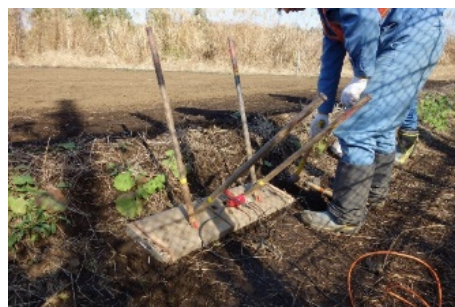
(d) 弾性波トモグラフィ（起振状況）
