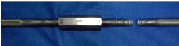
(f) ネジ部の引張破断 (M16)
