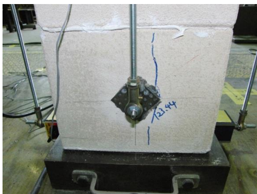
(k) 初ひび割れ (P-C-A42-3 の北面)
