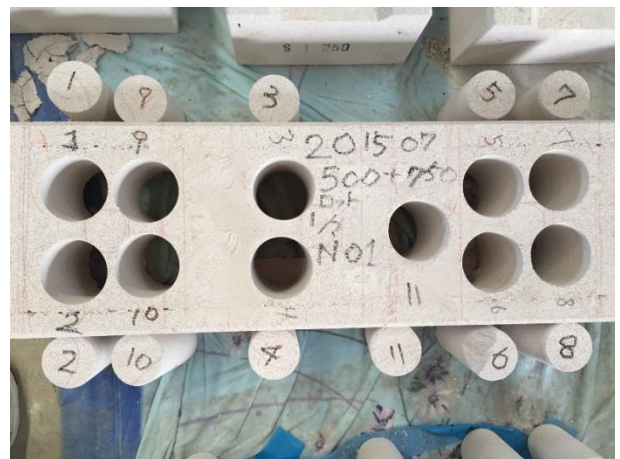
(d) φ64×128mm 試験体の採取状況
