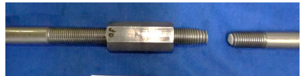
(g) ネジ部の引張破断 (M22)
