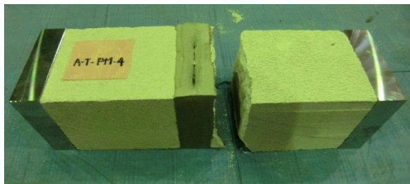
(b) 破壊性状①+② (JB-T-A50-PM-4)
