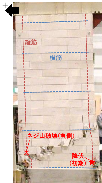
(c) InW-A50-w15 (曲げ降伏後のせん断破壊)
