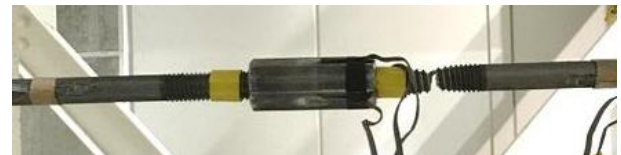
(i) ネジ部の引張破断 (M20)
