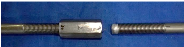
(h) ネジ山のせん断破断 (M22)
