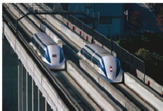
写真-1.2.2.2 高速すれ違い走行試験
