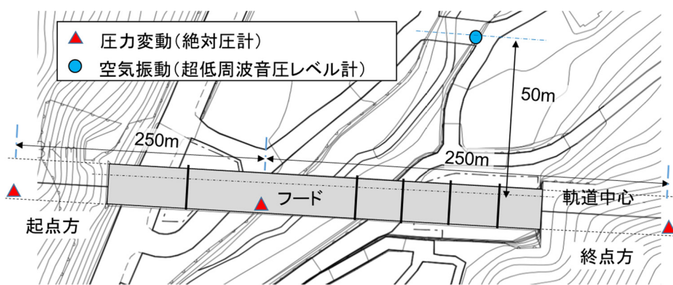
図-6.5.2.12 圧力変動，空気振動の測定位置
