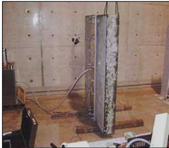
図-3.4.1.2 気流音に関する定置試験の状況
