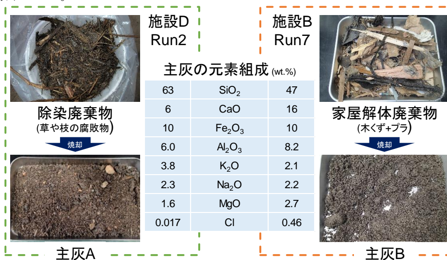
図 3.31 試料の外観および主灰の主要元素組成（元素組成は XRF により測定）
