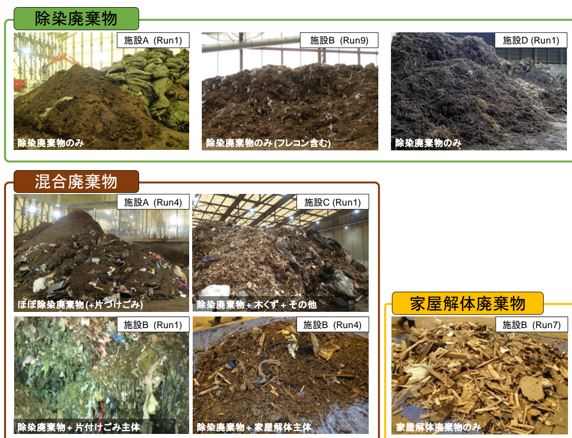
写真 3.1 代表的な焼却対象物の外観
