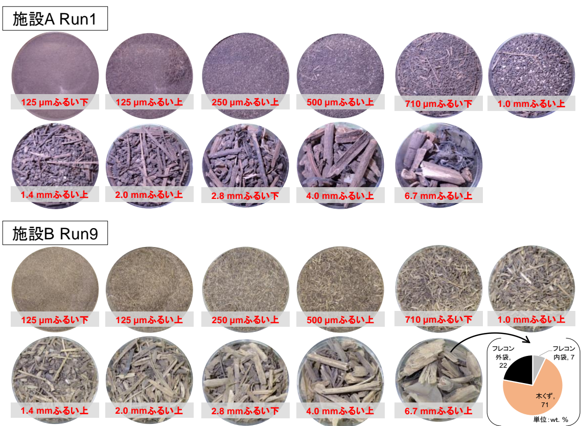
写真 3.2 除染廃棄物の粒径毎の外観（乾燥後）. 円の直径は約 47mm.
