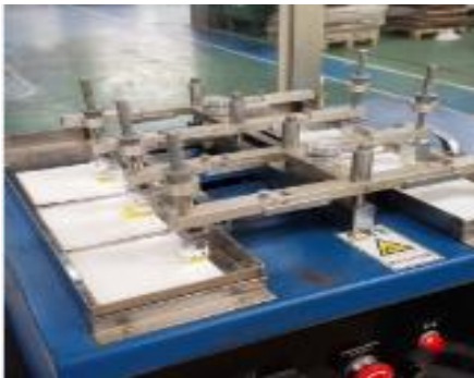
Fig.5-1 摺動試験機による汚れ除去試験の様子
