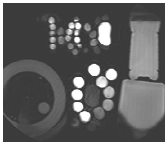
Figure 5.2 硫酸銅水溶液と油とファントム
