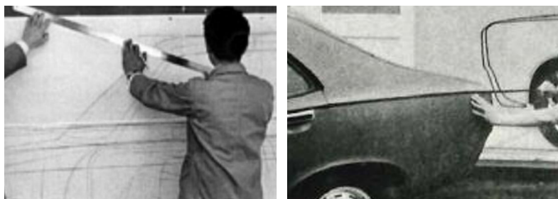
(a) カーブ定規のフィッティング (左図) とキャラクターラインの確認 (右図)
