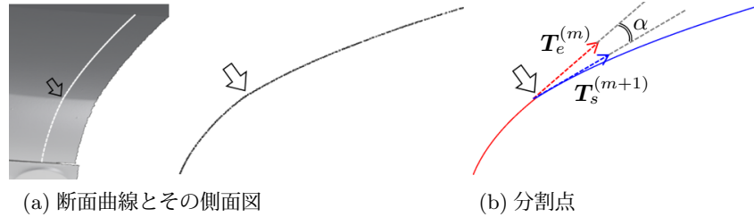
図 3.3. セグメント間の接続が滑らかでない曲線の例 [99].
