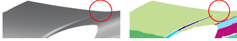
図 2.14. キャラクタライン端末の G^2 接続部の課題 [97]. 丸印の G^2 接続部では領域が分割できない。
