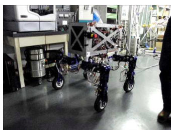
図 12.11: ZMP スラローム軌道追従時のロボットモーション (実験)
