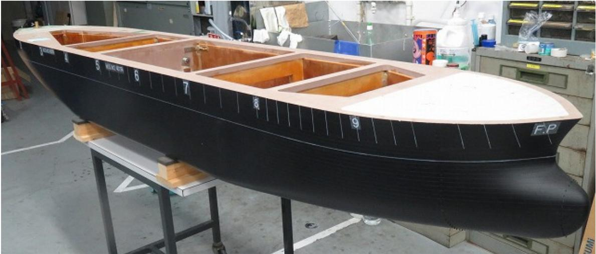
Fig.3.1 Model of KVLCC2
