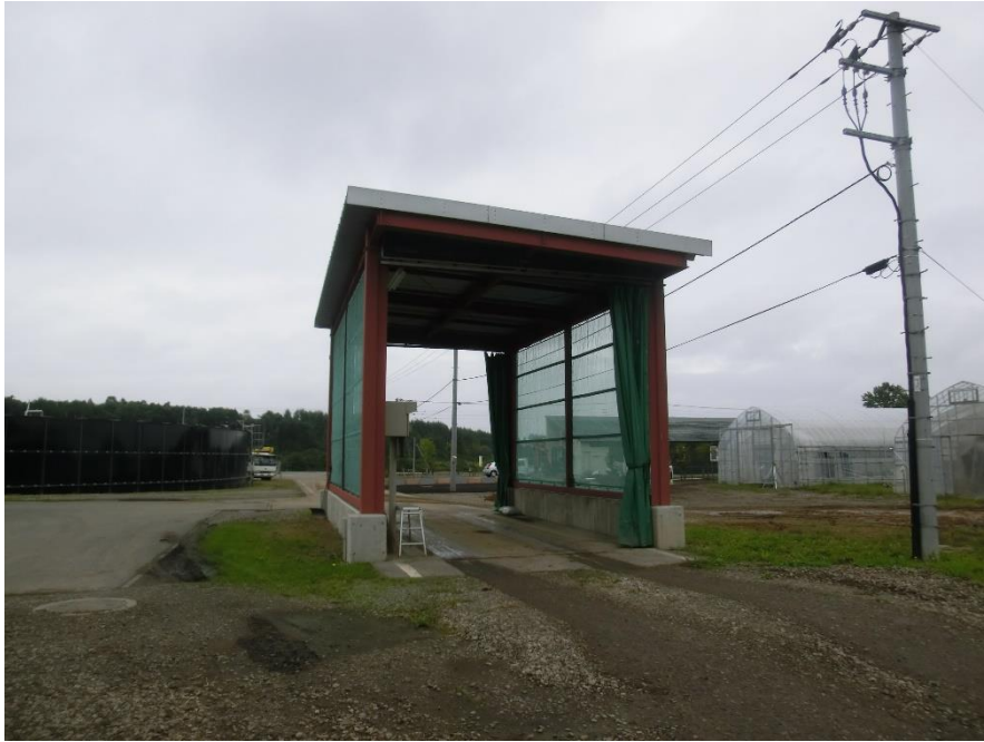
付録-写真 3 バイオガスプラントのトラックスケール (2013年9月に筆者撮影)
