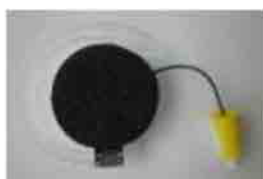
図9 改良型耳装着型体温計
