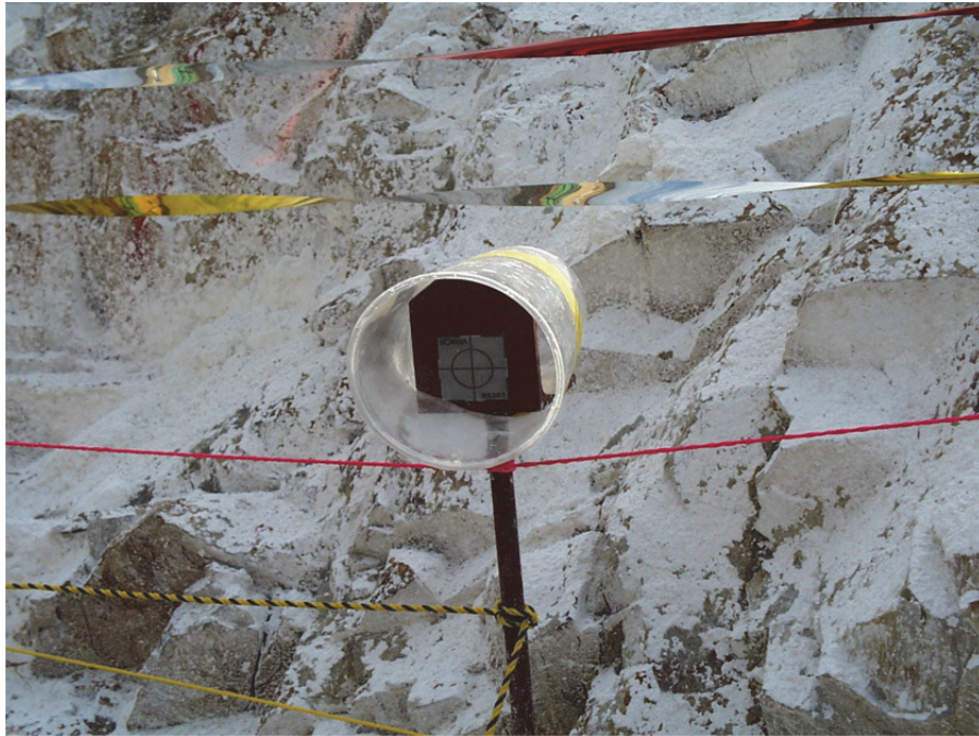
(1)光波測量ターゲットの拡大写真
