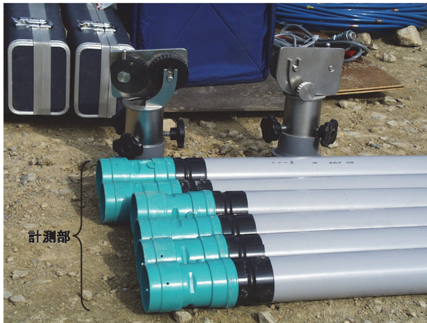
(1)地中変位計測用のケーシング
