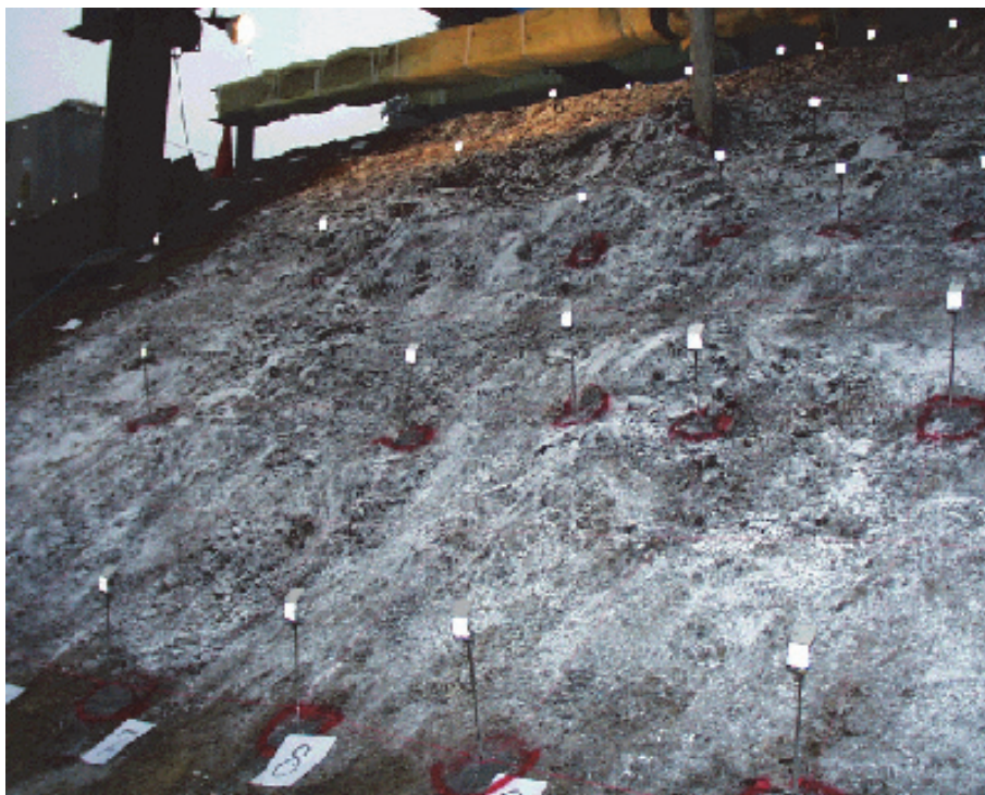
(2)光波測量ターゲットの設置状況
