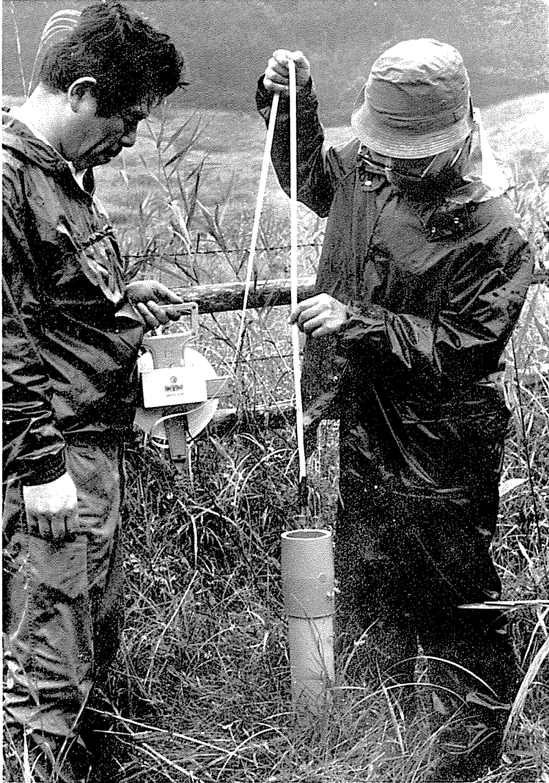
Phot. 2. 水位測定状況。 Grundwassermessung.
