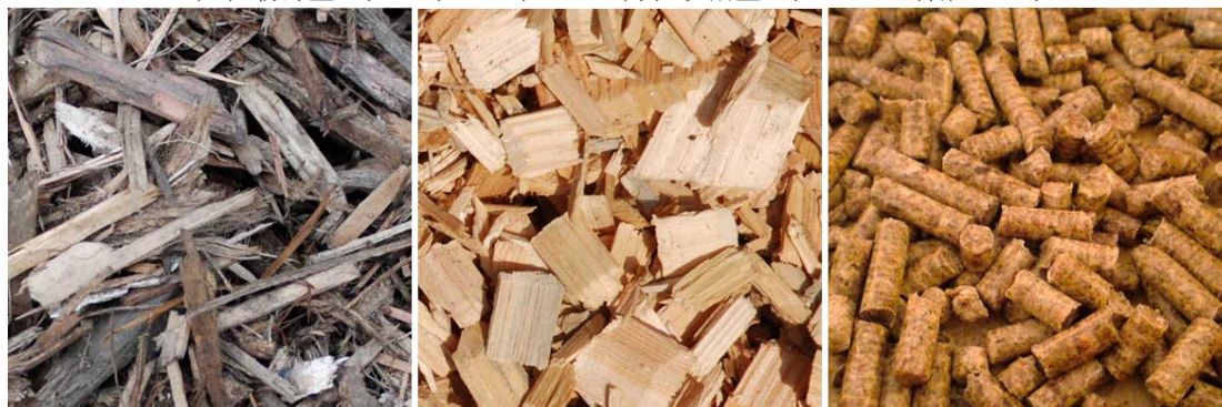
図 4-5 主要な燃料の特性 (左) 粉碎型チップ (バーク) (中) 切削型チップ (右) ペレット
