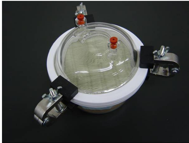
Fig. 2-7 試料封入後の小型チャンバーの写真（畳試料）
