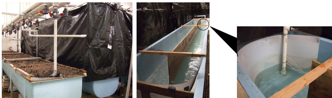
図 16. 実験 2-2 に用いた回流水槽。周囲を黒いビニールシートで覆い、右写真のように水を流入させた。
