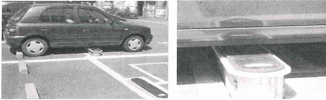
図 5.4.3-2 昇降式ロックプレート利用例
