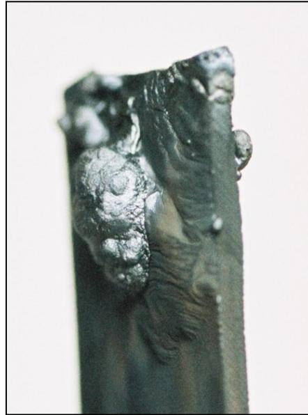
図 6-18. 難燃試験後の E-NEO 硬化物の発泡痕 (燃烧皮膜)
