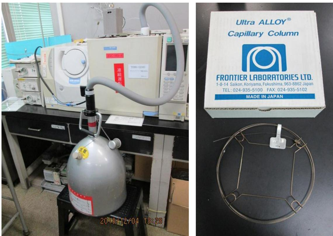
図6-29. 装置および金属キャピラリーカラムの外観
