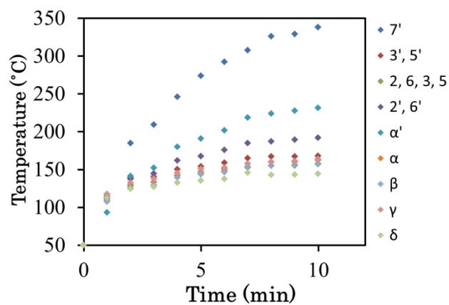
**Figure 4.4 MBBA** におけるマイクロ波照射時間による温度プロット(A) 65 W, (B) 130 W (C) 195 W
