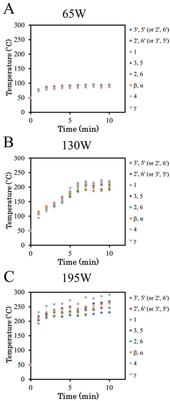
**Figure 3.8** PCH3 におけるマイクロ波照射時間による温度プロット(A) 65 W, (B) 130 W (C) 195 W
