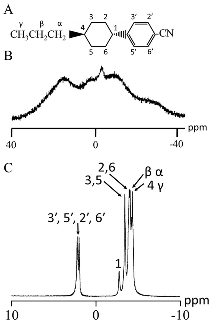
**Figure 3.1** PCH3(A) 分子構造 (B)  $40^\circ\text{C}$  (液晶相) の  $^1\text{H}$  NMR スペクトル (C)  $50^\circ\text{C}$  (等方相) の  $^1\text{H}$  NMR スペクトル.
