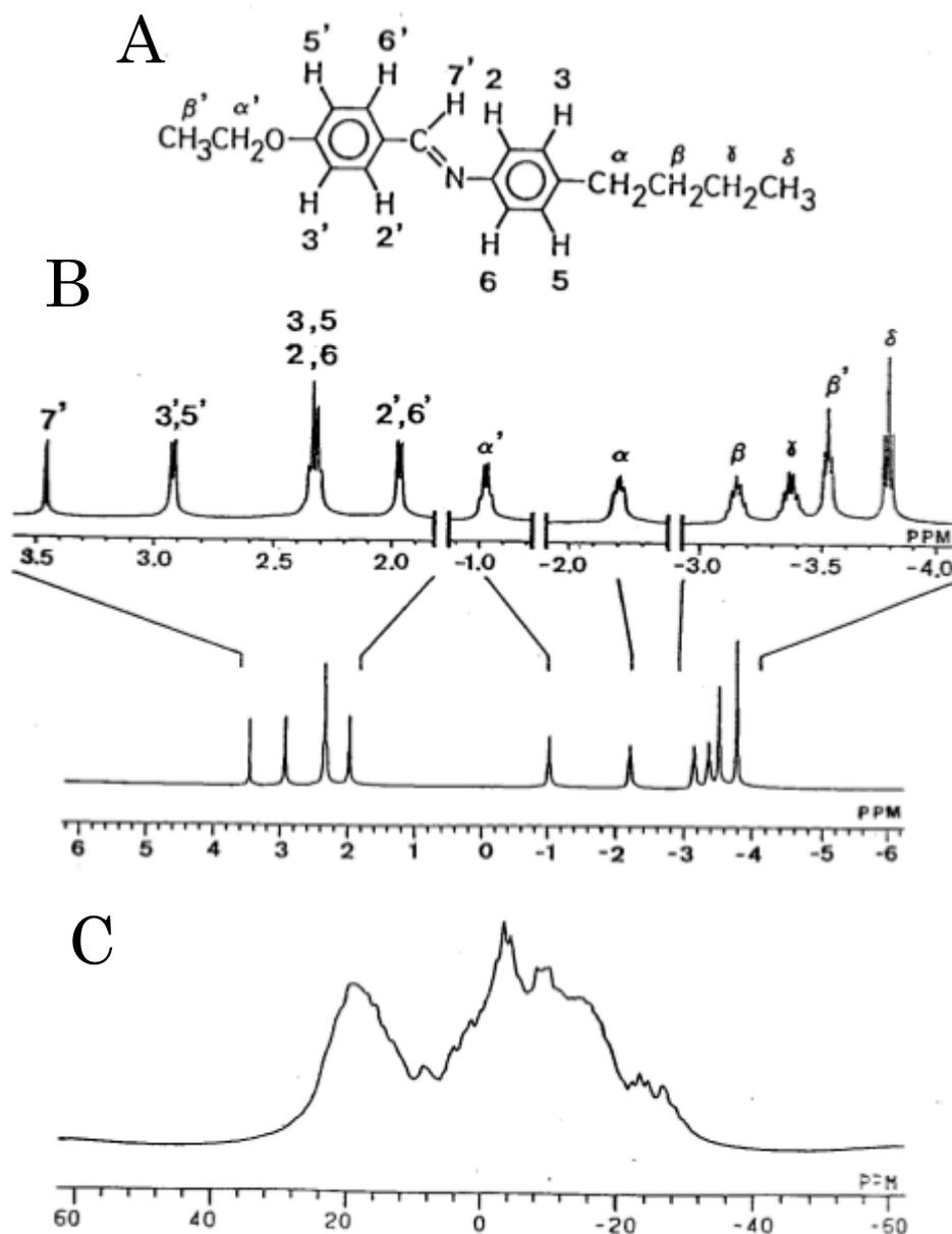
Figure 5.1 EBBA の(A) 分子構造 (B)  $78^\circ\text{C}$  (液晶相) の  $^1\text{H}$  NMR スペクトル (C)  $82^\circ\text{C}$  (等方相) の  $^1\text{H}$  NMR スペクトル.
