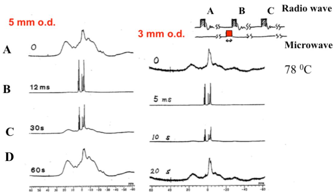
**Figure 5.3** EBBA の  $^1\text{H}$  NMR スペクトル (サンプル管の径 左 : 5 mm 右 : 3 mm)
