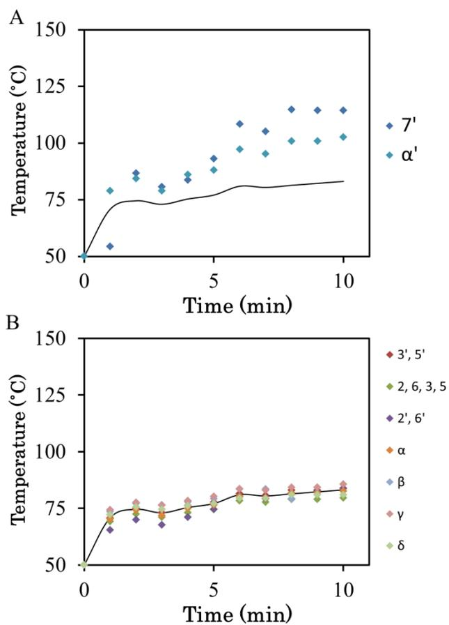
**Figure 4.5** Figure4.4(A)におけるマイクロ波照射時間による温度プロット(A:7',α' B:それ以外) グラフ中の線はBの平均値を示している。
