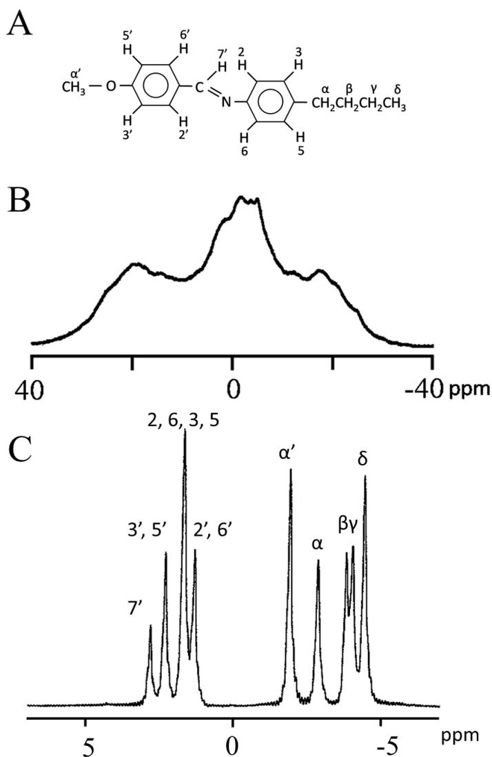
Figure 4.1 MBBA の(A) 分子構造 (B)  $35^\circ\text{C}$  (液晶相) の  $^1\text{H}$  NMR スペクトル (C)  $50^\circ\text{C}$  (等方相) の  $^1\text{H}$  NMR スペクトル。
