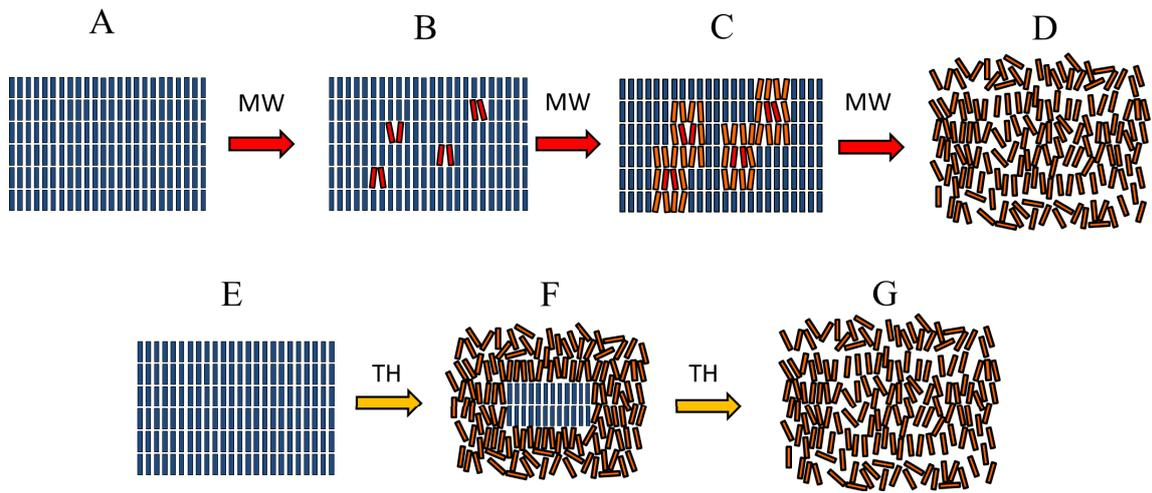
**Figure 3.5** 液晶分子のマイクロ波加熱と通常加熱の違い
