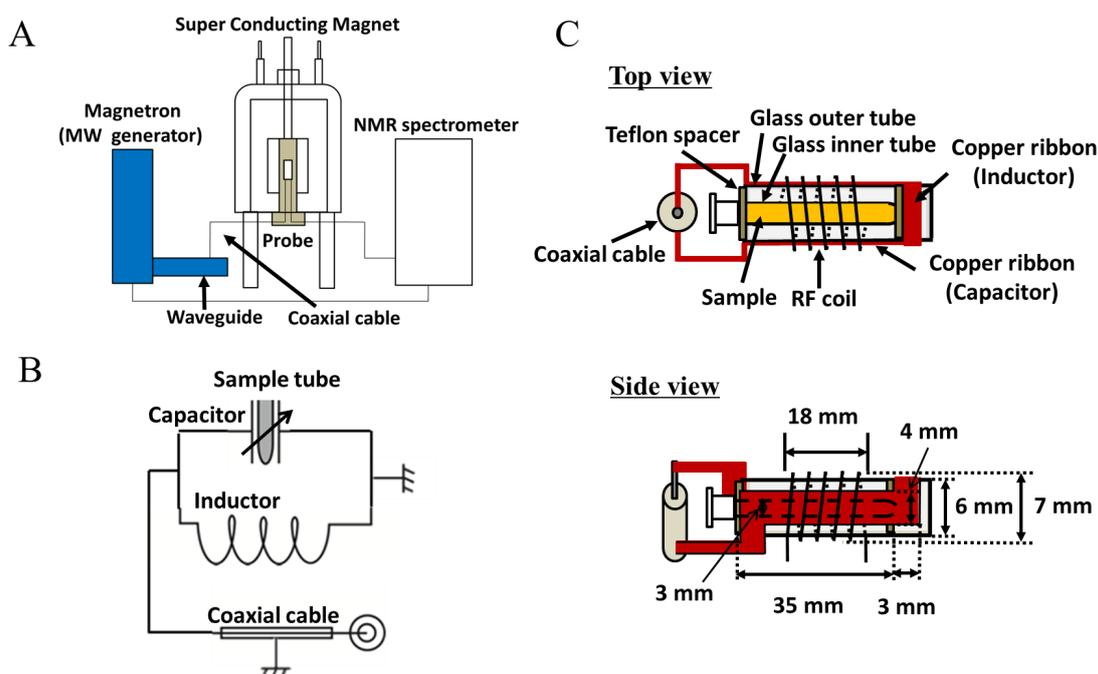
Figure 2 (A) *in-situ* マイクロ照射 NMR 分光器 (CMX Infinity 400, Chemmagetics)の模式図 (B) マイクロ波回路 (C) サンプル管、マイクロ波回路およびラジオ波回路の模式図 上：上面図 下：側面図
