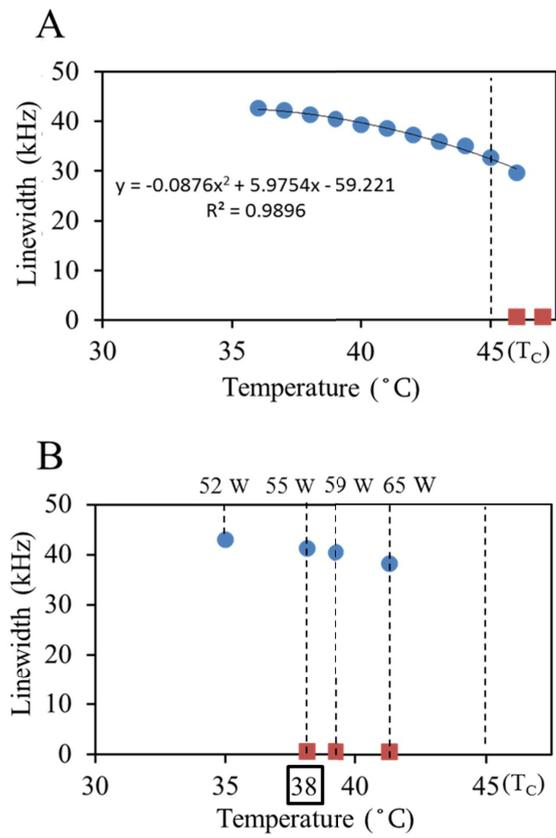
**Figure 3.4** PCH<sub>3</sub> の <sup>1</sup>H NMR スペクトルの線幅と温度の関係
