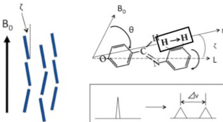
Figure 3.2 液晶分子の磁場配向の様子（左）と双極子パターンの分裂幅（右）の関係
