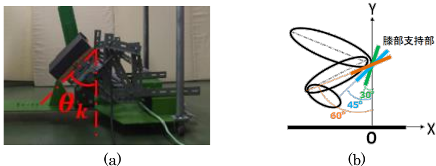
Fig.2-14 膝部支持部の角度の設置
