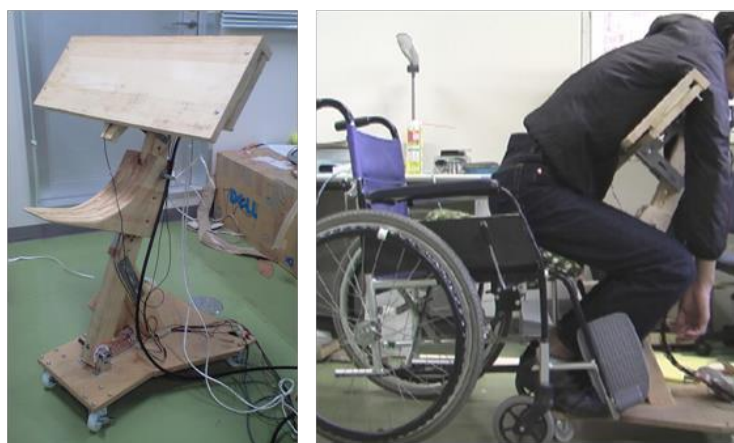
Fig.1-8 試作機Ⅰの構成及び移乗姿勢
