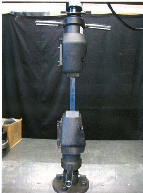
図 2.9 1軸引張実験の様子(ひずみ速度1～100%/min時)
