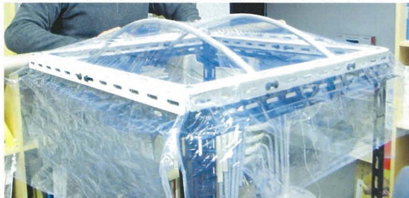
(b) 外部引き込みによる延伸成形
