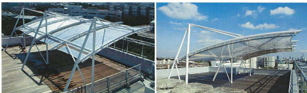
図 5.2 延伸成形によるテンション方式の実証実験
