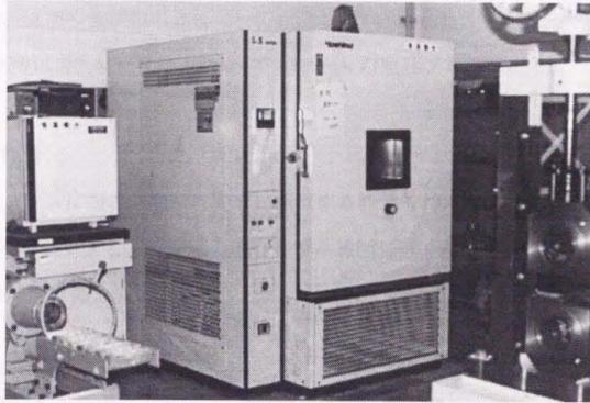
図 2-8 恒温炉
