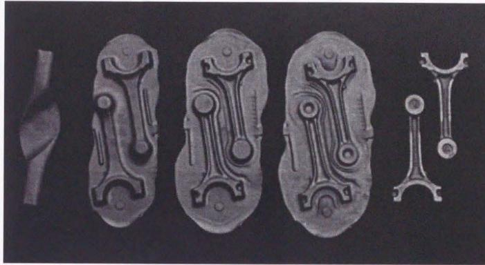
図 5-1 コンロッド鍛造工程図
