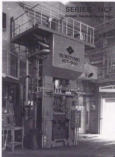
図 2-2 鍛造シミュレータ外観図
