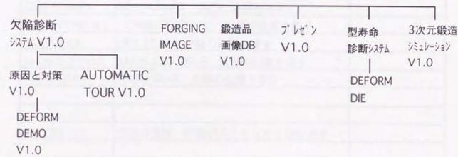
本仕様書で扱う"鍛造欠陥診断システム"で取り扱うカードの構造は、次の通りである。
