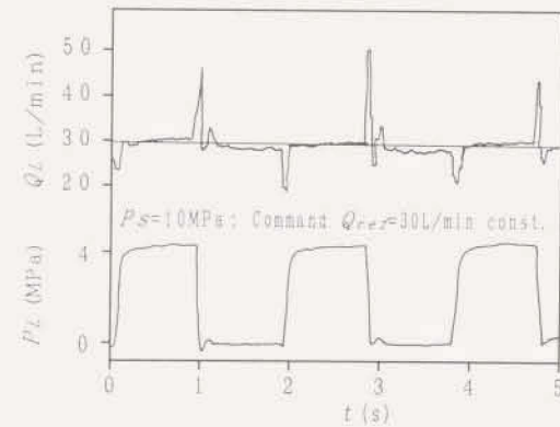
図4-88 ステップ負荷圧力変化に対する流量制御特性 (目標流量 Q_{ref} : 30L/min一定に設定)
