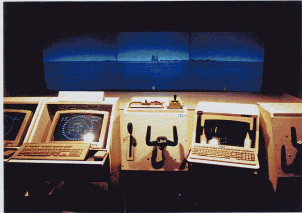
写真 1.1 前期操船操作システム
