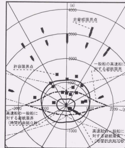
図2.16 一般船に対する高速船の避航開始位置 一般船：小型船 高速船：ジェットフォイル 操船者：大型船舶長経験者B
