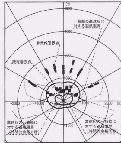
図2.11 一般船に対する高速船の避航開始位置 一般船：小型船 高速船：カタマラン 操船者：内航小型船船長経験者
