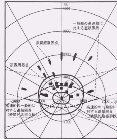
図2.10 一般船に対する高速船の避航開始位置 一般船：小型船 高速船：ジェットfoil 操船者：内航小型船船長経験者
