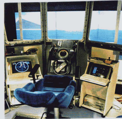
写真 1.3 後期操船操作システム
