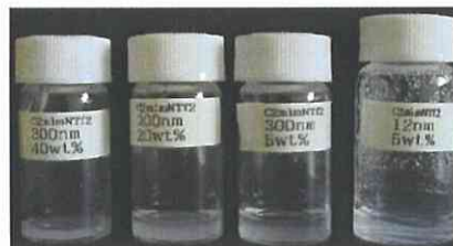
Figure 3-12. サイズの大きなシリカ微粒子を [\text{C}_2\text{mim}][\text{NTf}_2] に添加した時の外観変化。
