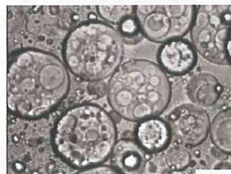
Figure 1-27. シリカナノ粒子によって安定化されたオイル/イオン液体/水の多相エマルジョン. (ref. 1-76 Binks, B. P.; Dyab, A. K. F.; Fletcher, P. D. I. Chem. Commun. 2003, 2540.より抜粋)
