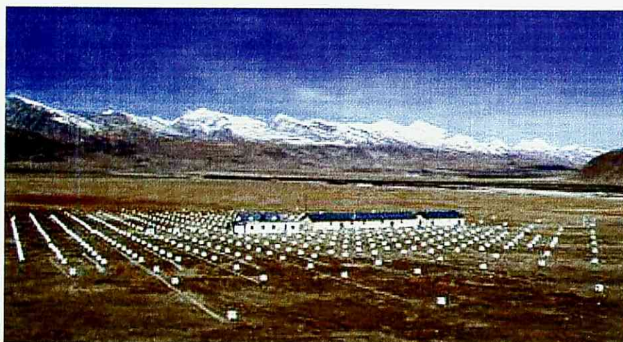
図 2.1: 1999 年 11 月に完成したチベットの空気シャワーアレイ。300 m \times 300m の面積に白いビニールで覆われたシンチレーション検出器が 7.5m 間隔で配置されている。左側の建物にデータ収集室と実験室がある。真中の大きな建物 (400 m 2 ) にはエマルジョンチェンバーとバースト検出器, 右側の建物 (100 m 2 ) には太陽中性子モニターが設置されている。[53]
