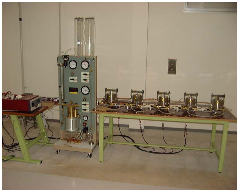
写真 2-6 港研式分割型圧密試験装置（姜ら，2001）
