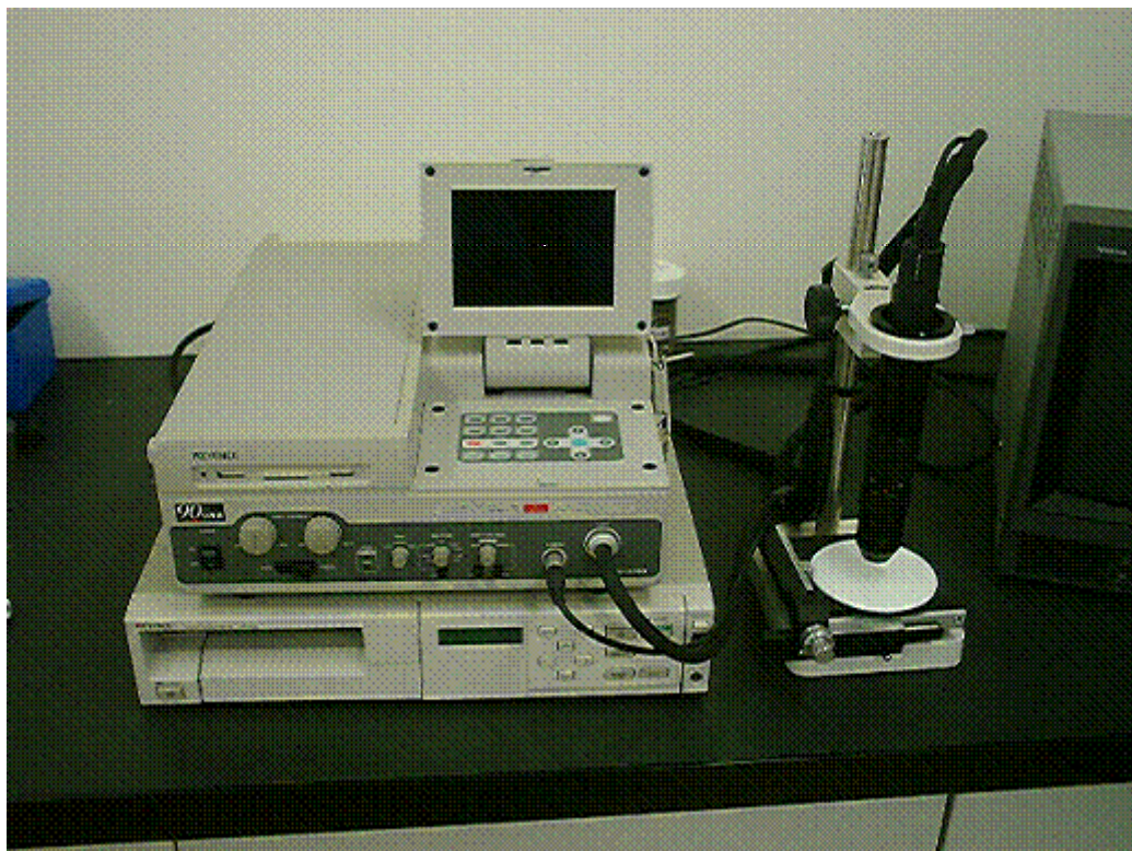
写真 2-5 デジタル顕微鏡（キーエンス製，VH-6300）
