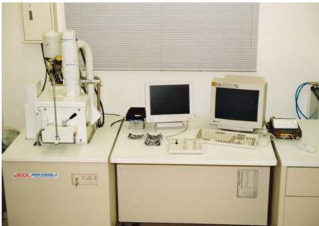
写真 2-4 走査型電子顕微鏡 (日本電子株式会社製, JSM-5900LV)
