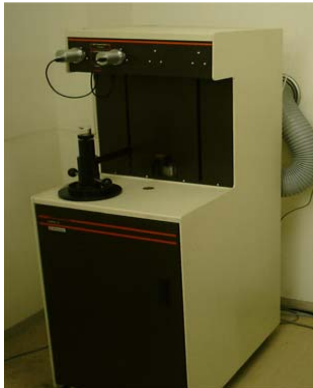
写真 2-3 水銀圧入型ポロシメータ試験装置 (マイクロメリティクス社 : Autopore III 9400)
