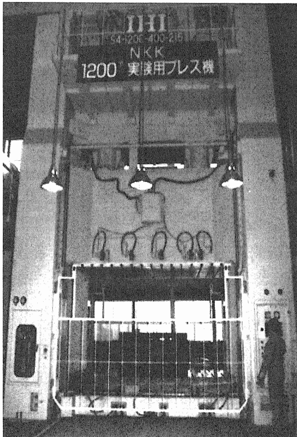
Fig. 3.2 11800kN シングルアクションメカニカルプレス機の外観
