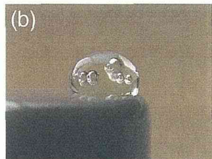
図10 (a)磁気浮上炉で作製したZEONEXの球状試料, (b)ゼロ磁場で作製した試料
