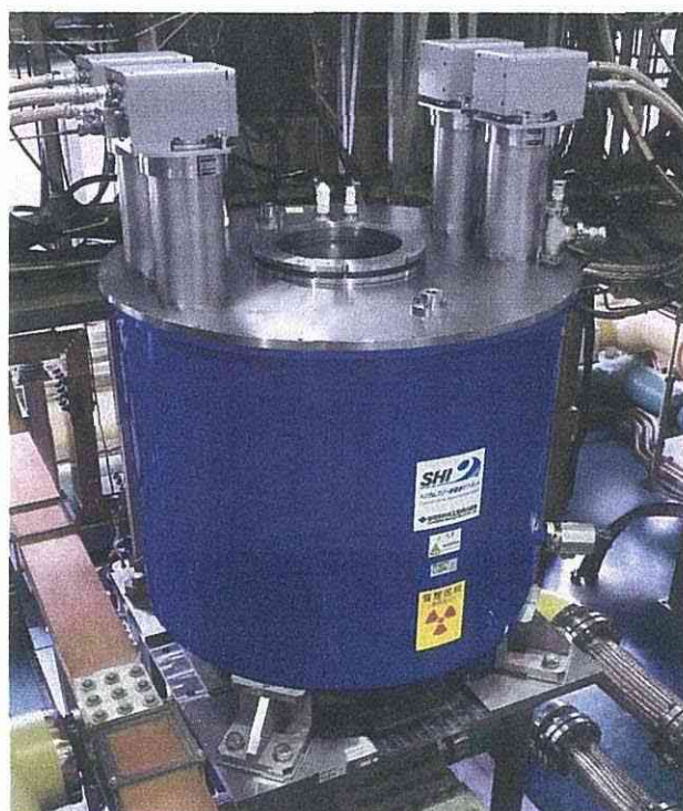
図2 東北大学の無冷媒型ハイブリッドマグネット。無冷媒型超伝導マグネットの内側に大電力水冷マグネットが組みこまれている
