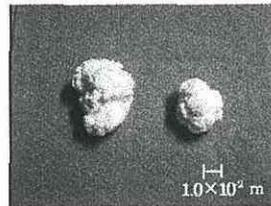
図1 攪拌翼周辺に生成した凝集塊の一例
