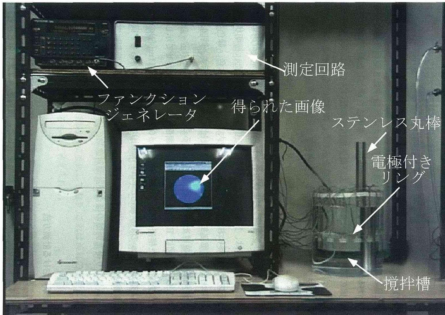
図3.9 当研究室にて試作した電気抵抗方式
