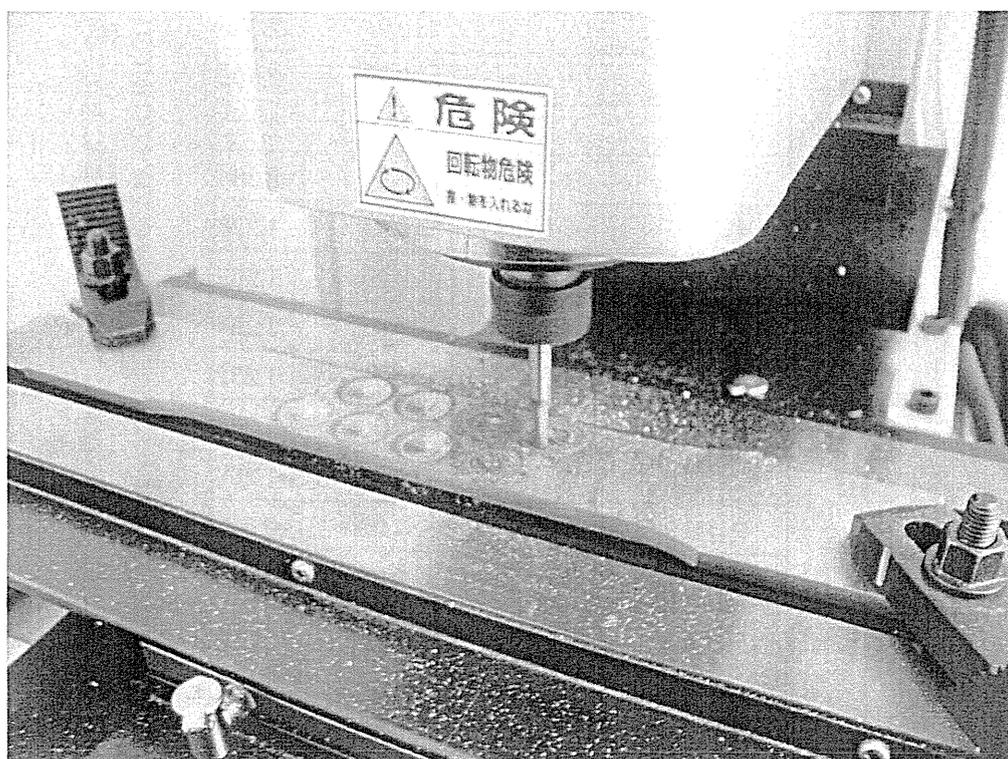
図 A1.3 SGO 1 による人工ピット加工の様子
