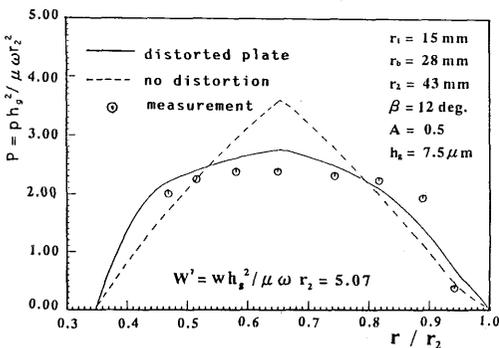
図3 圧力分布の計算結果と実測結果の比較
