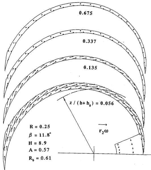
図5 速度ベクトル(zは回転壁からの距離)
