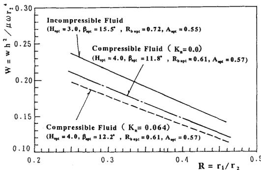
図 14 最適寸法における  $W$  の内外径比  $R$  に対する変化
