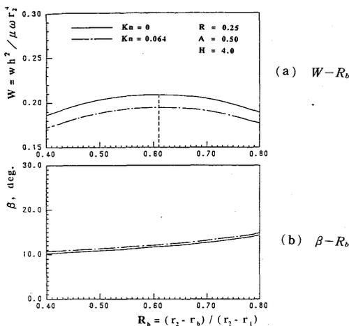
図12 最適寸法の決定(圧縮性流体の場合)
