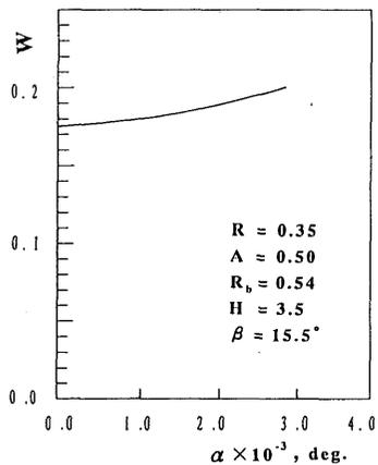
図 16 軸受面傾斜が負荷容量に及ぼす影響
