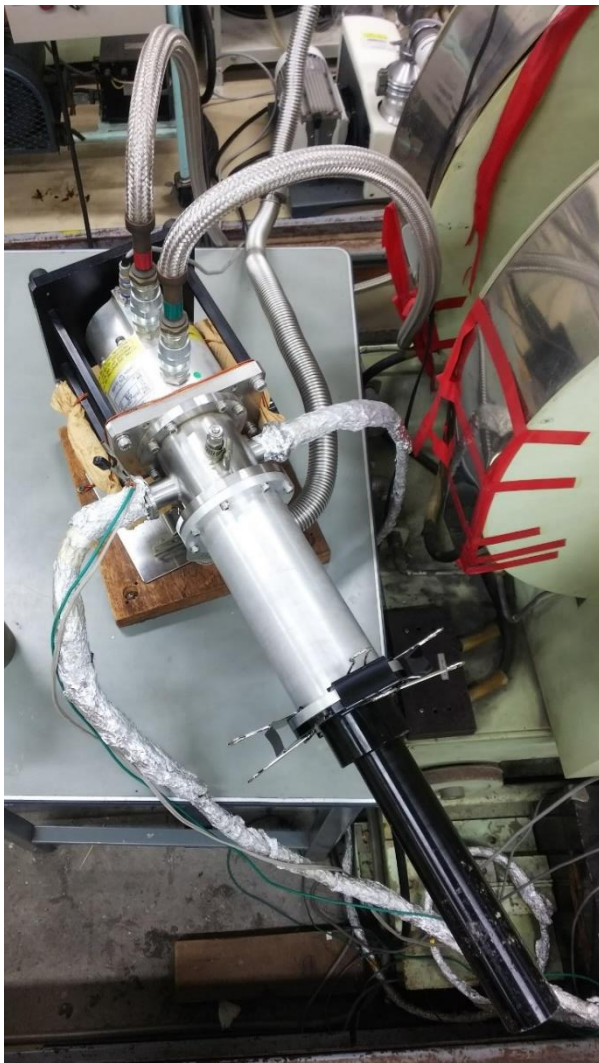
Fig. 2-6-2 (左)電気抵抗・熱電能測定用 10 K GM 冷凍機の外観、(右上)コールドヘッド部分、(右下)端子付けされた測定試料(目盛は 0.5 mm)
