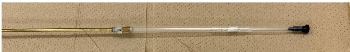
Fig. 2-7-2 SQUID 磁化測定に用いる試料のセッティング
