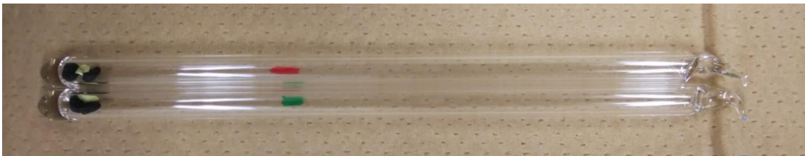
Fig. 2-1-3 (上)アルミナ製ボートに載せた試料ペレット。(下)ガラス管に真空封入した試料。
