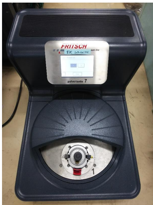
Fig. 2-1-4 ボールミル装置の外観
