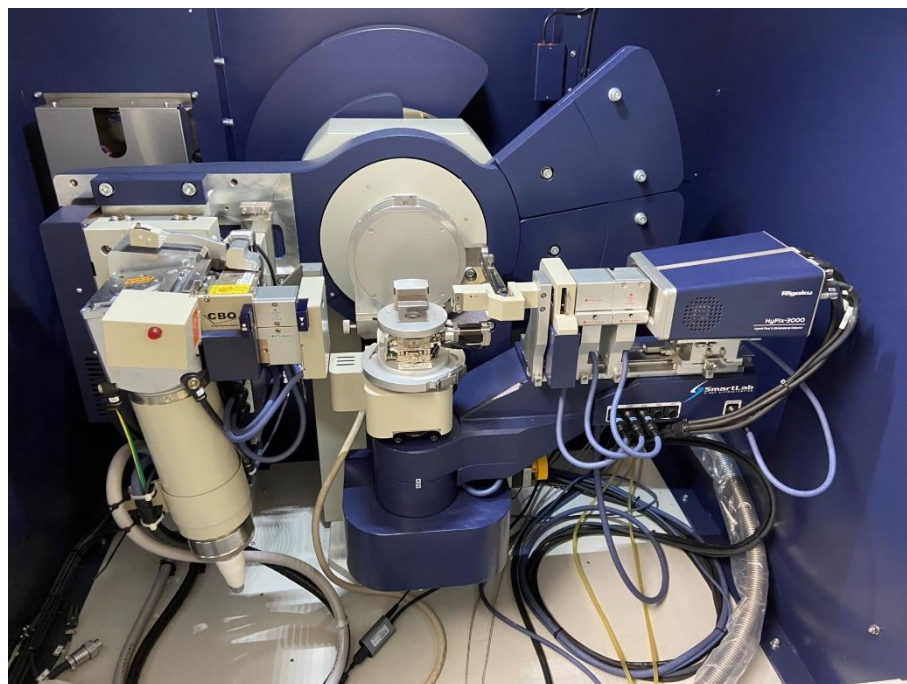
Fig. 2-2-1 多目的 X 線回折装置 SmartLab の光学系
