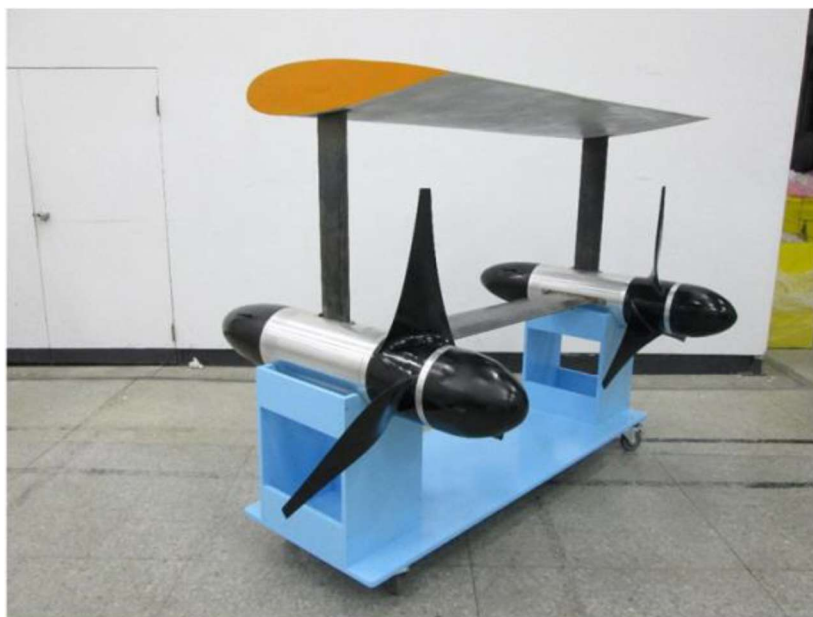
図 1.2.4 台湾 Tsai らによる双発式海流発電装置モデル 14)
