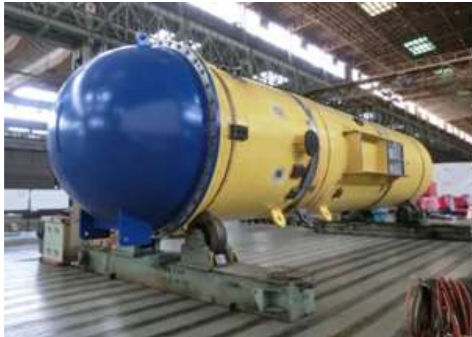
図 2.3.9 ポッド単体耐圧試験の様子
