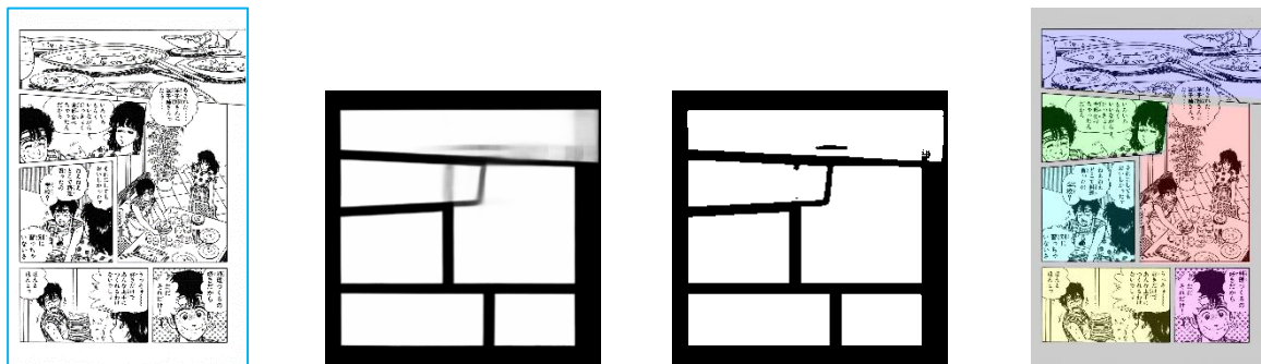
図 4-8. 特徴的なコマを有する画像例(i)~(x) 左から順に, 入力画像(左端, 外枠の青線は著者が追加), CNN の出力(グレースケール)画像, CNN出力の二値化画像, コマ領域ごとに着色した画像(右端)
