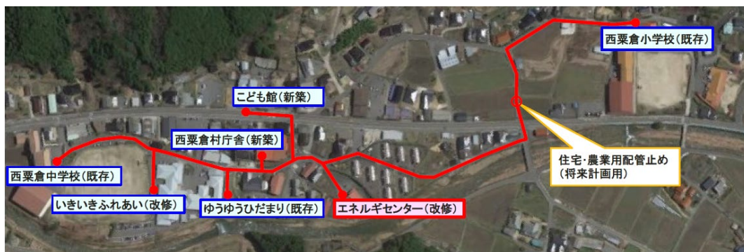
図-1.13 西粟倉村における熱供給配管網 1-33
