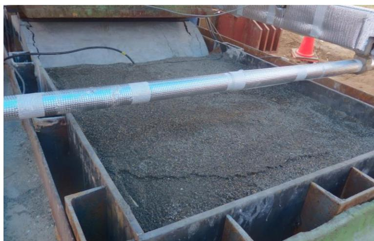
図 2-24 沈下変形した試験体周辺地盤
