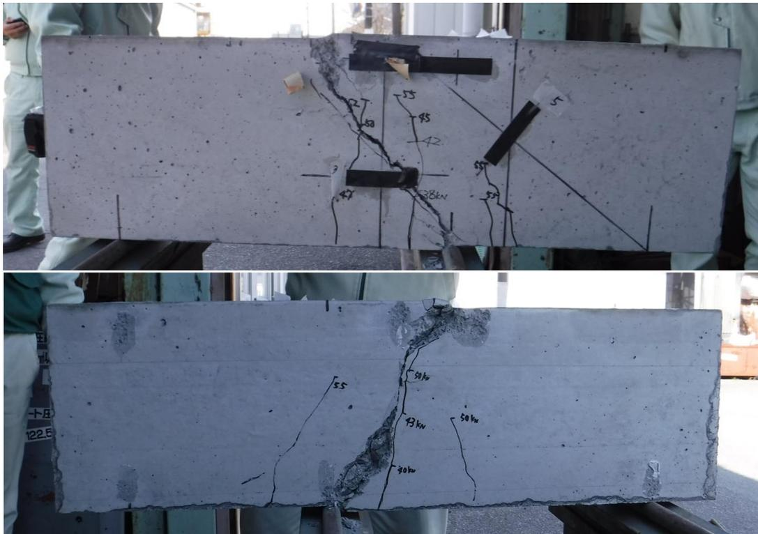
図 2-14 RC 梁の曲げ試験+せん断試験の破壊モード
