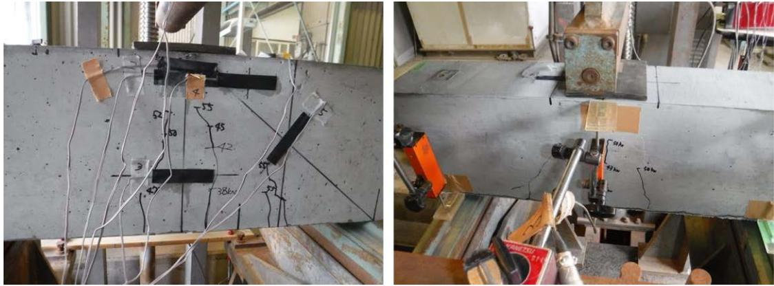
図 2-13 曲げ試験終了時のひび割れの様子
