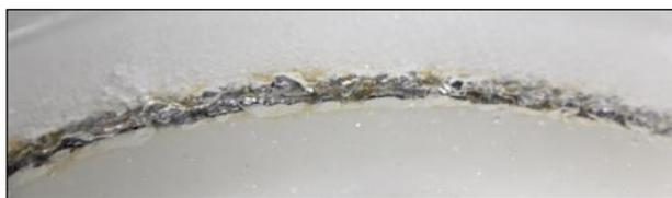
a) 塩化ナトリウムを混ぜた範囲の鋼材の様子
