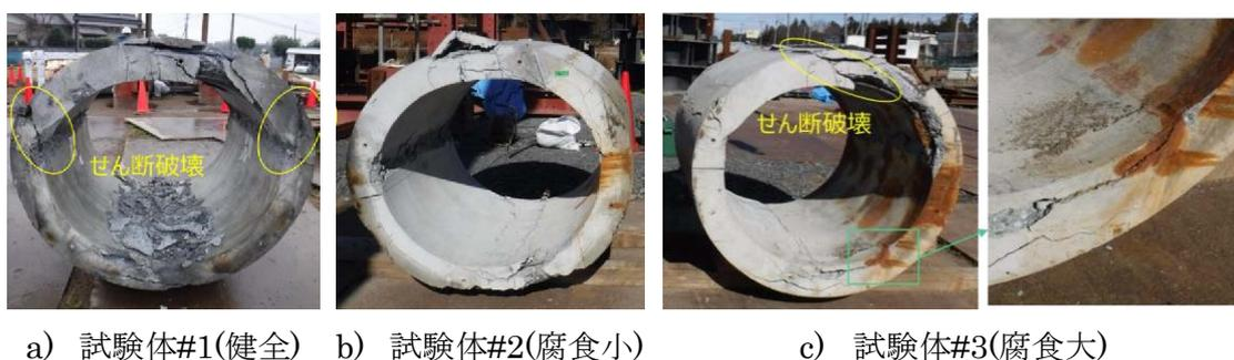
図 2-8 実験の各ケースでの試験体の破壊性状
