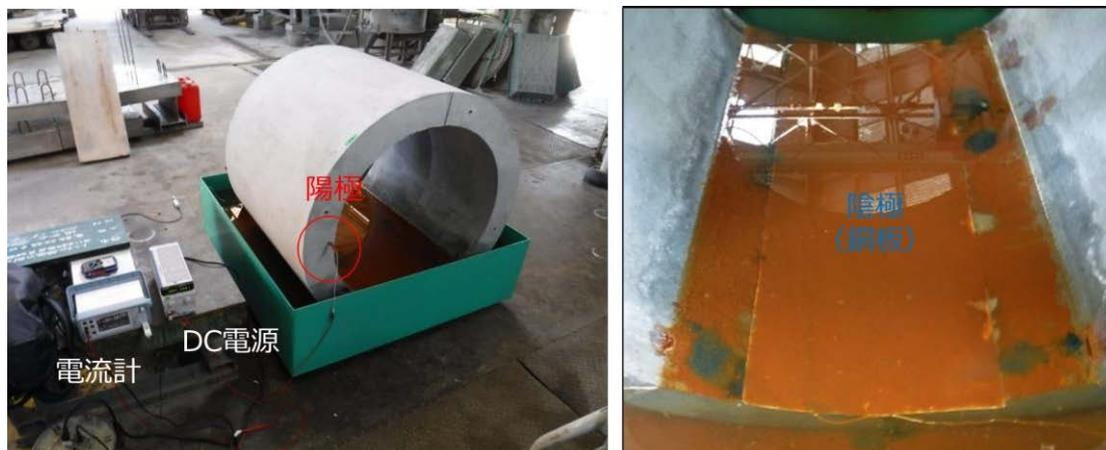
図 2-2 試験体の電気腐食の様子
