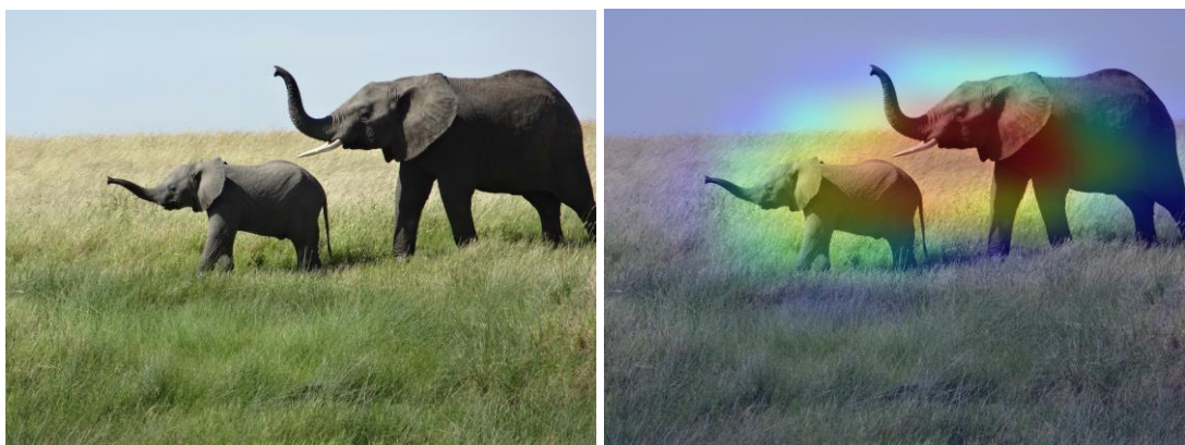
図 2-17 ImageNet訓練済みXceptionを用いたGrad-CAMの例 (block14_sepconv2_act層の出力を利用)
