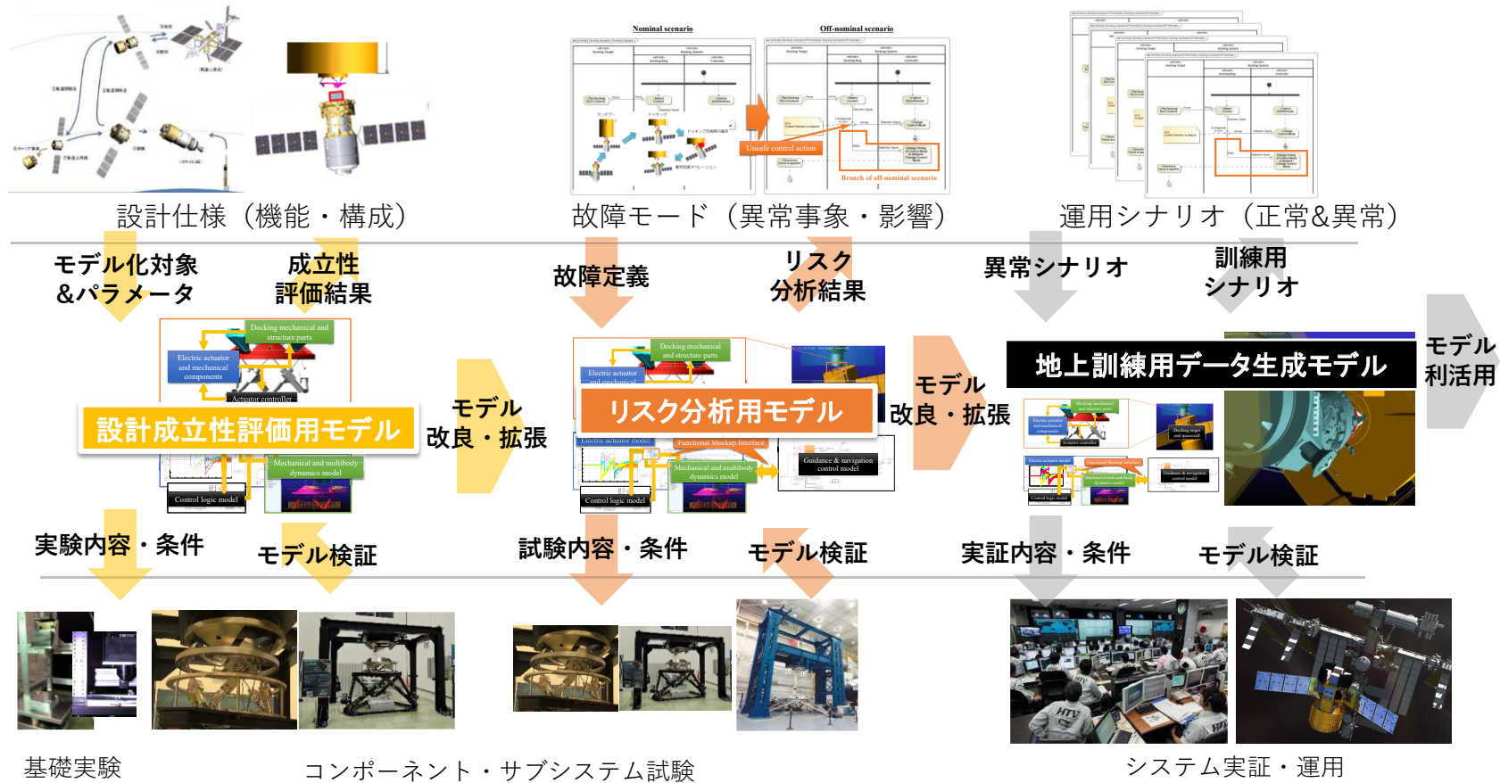
図 4-30. 宇宙機自動ドッキングシステムを対象とした適用事例 [138]
