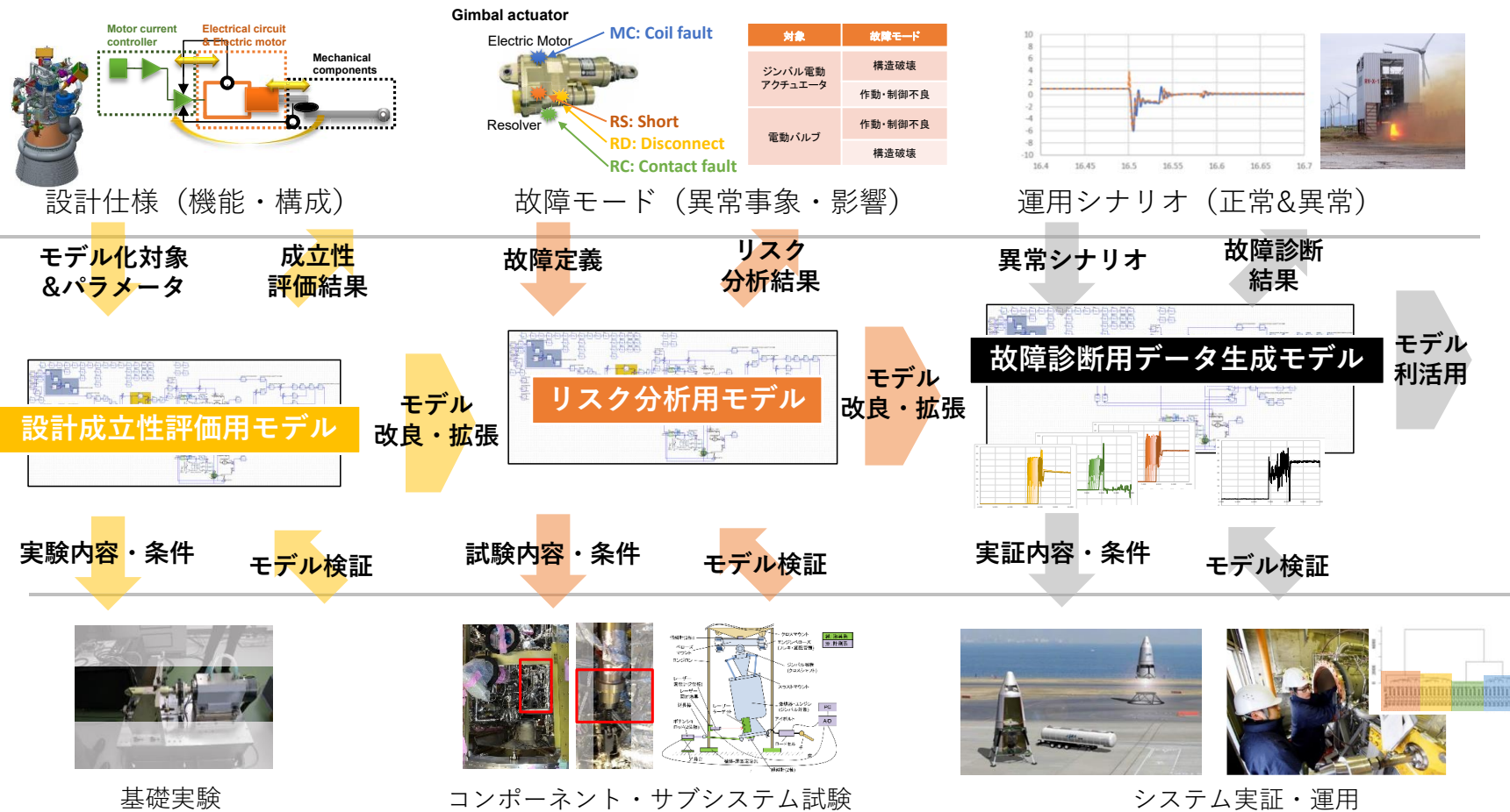
図 4-31. 再使用ロケットエンジン推力制御システムを対象とした適用事例 [139]
