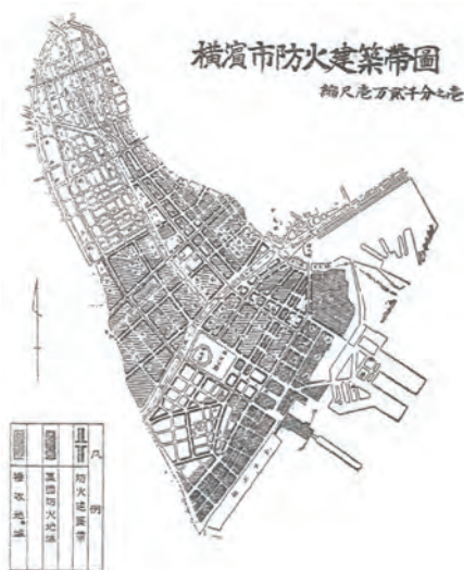
図5 横浜市防火建築帯計画図 関東大震災時は総延長約16〔km〕だったものが、終戦直後に約32〔km〕、1960年には約35〔km〕と延長された
