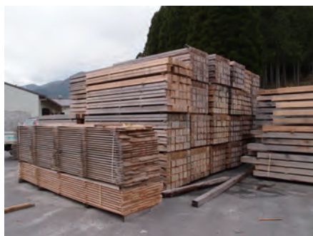
写真 8 木材を自然乾燥させている様子
