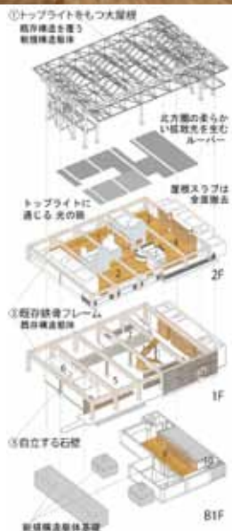
図9 既存の鉄骨フレームをトップライトを持つ新規の大屋根が覆う構成
