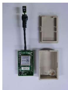
図 2 皮膚温度センサ、 衣服内気候センサ
