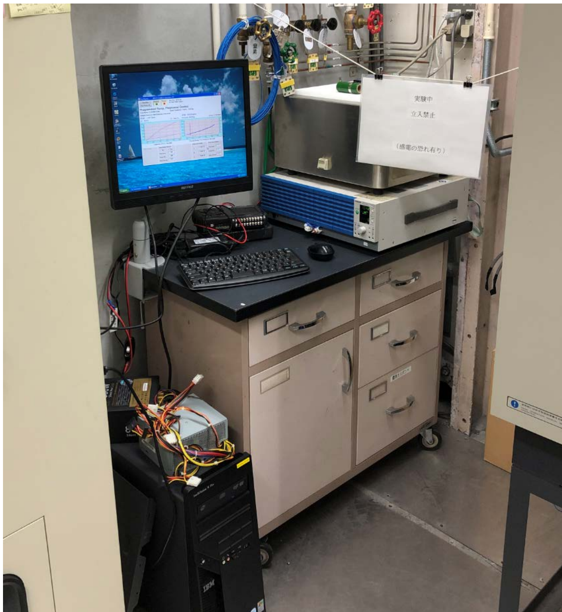
ARSST のインターフェースを使用した実験操作機器周りの様子 (ARSST 制御装置、直流電源装置、ARSST 制御 PC・モニター等)
