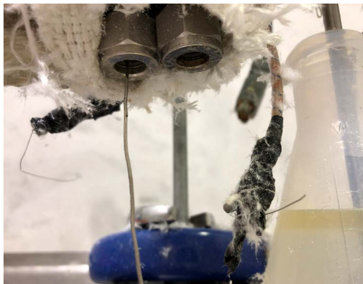
耐圧ガラス容器の接続部（中央継手）、ヒーター接続部（左右の切断されたニクロム線）
