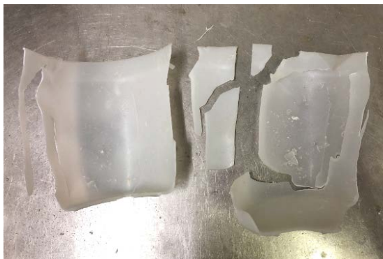
破裂の威力により裂けたプラカップ
