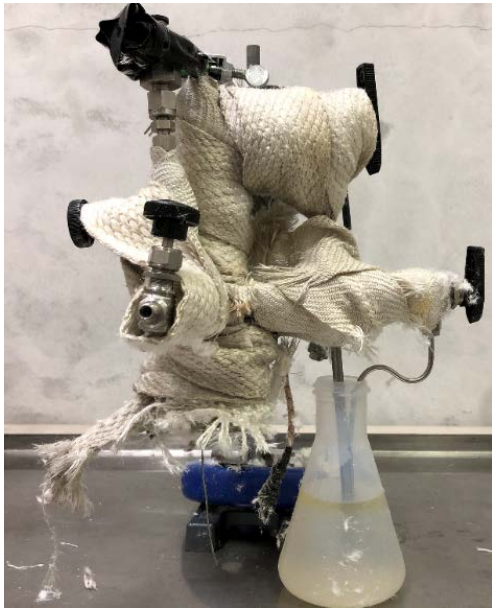
破裂の威力により装置全体が歪んだ状態
