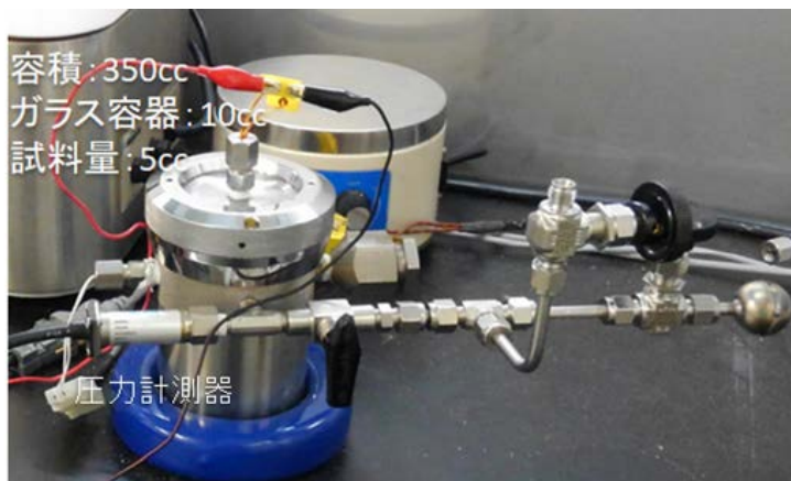
図 2-7 ARSST による暴走時の発生ガスの補足
