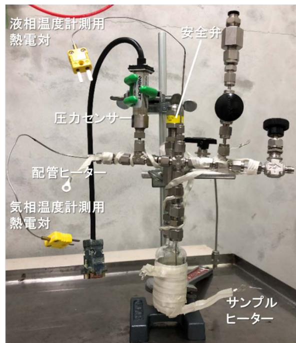
図 3-9 サンプルヒーターおよび配管ヒーターの設置状況
