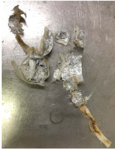
サンプルヒーター破損の様子
