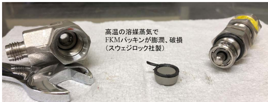
図 3-13 安全弁の FKM パッキンの破損
