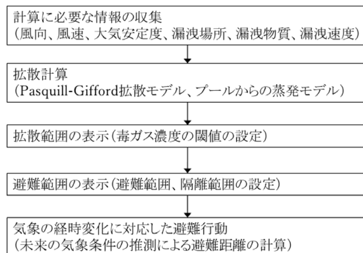
図 4-1 拡散計算から避難範囲決定までの一連のフロー図
