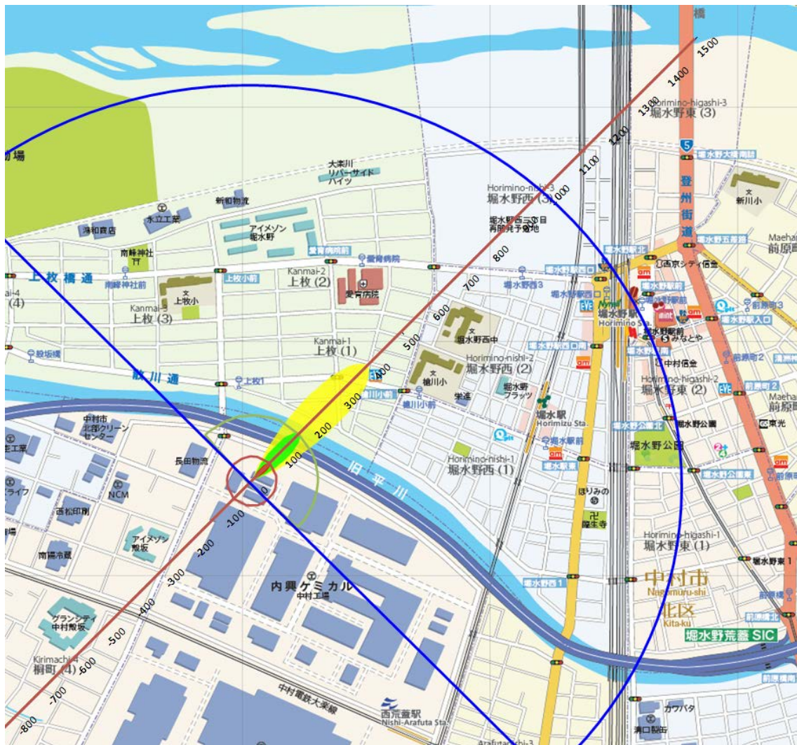
図 4-18 アンモニアの臭気 (5ppm) の拡散範囲の表示
