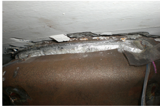
上部引張側状況 完全に鋼管が割れ、内部コンクリートが見えている。
