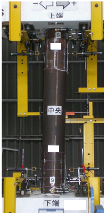
写真-3.3.3 損傷状況 (試験体(T) : + 3 \delta y )
