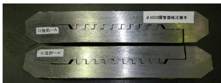
写真-4.4.3 改良継手構造の検証実験最終状況
