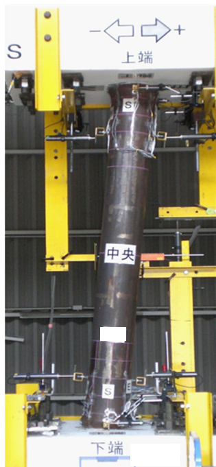
写真-3.3.6 損傷状況 (試験体(S) : + 6 δ y)
