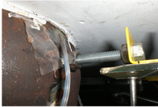
上部圧縮側状況 孕み量は約12mm程度
