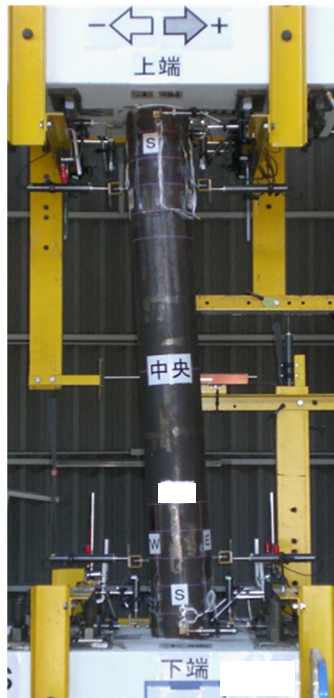
写真-3.3.5 損傷状況 (試験体(S) : - 3 δ y)
