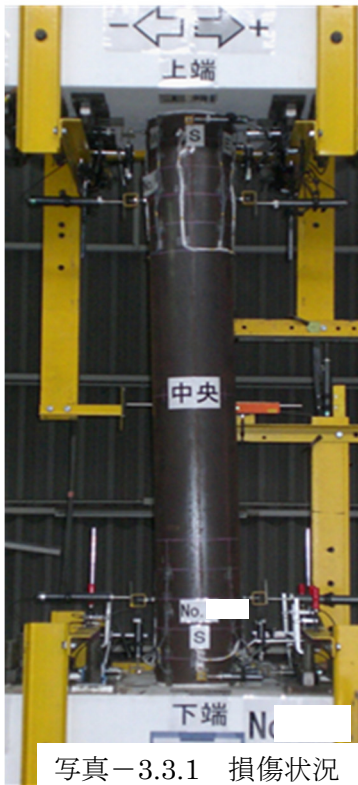
上部圧縮側状況 孕み量は約12mm程度
