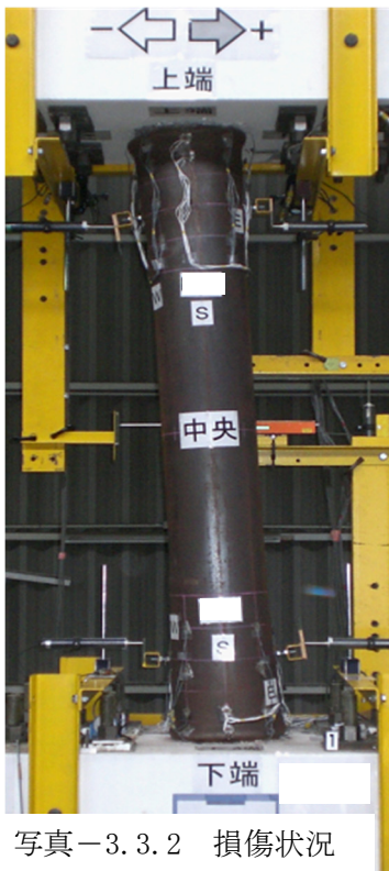
上部引張側状況 完全に鋼管が割れ、内部コンクリートが見えている。
