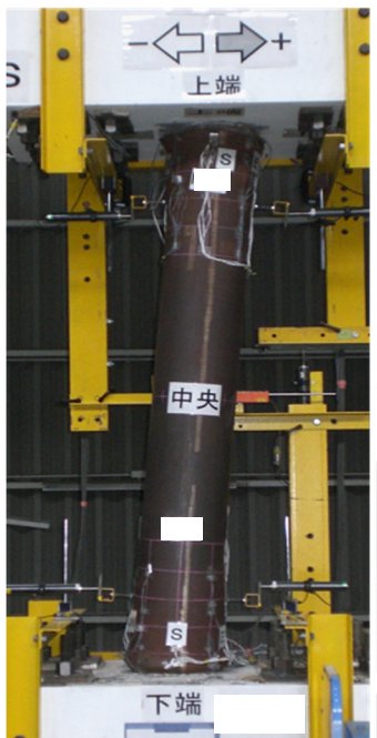
写真-3.3.4 損傷状況 (試験体(T) : + 8 \delta y )
