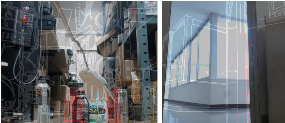
Fig. 6.41 カラーマップの情報を追加したステレオマッチングインタフェース
