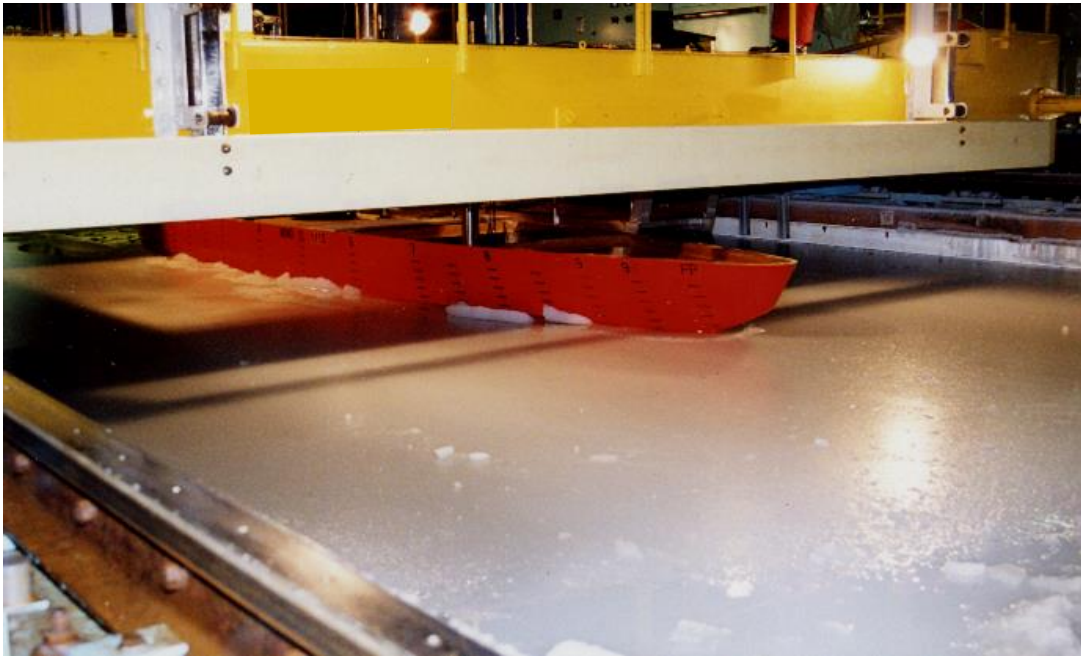
図 1.1.1 氷海水槽試験(ジャパン マリンユナイテッド株式会社 氷海水槽)
