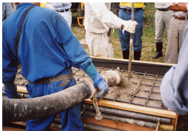
写真-4.2.3 部分供試体②の打ち込み・締め固めの状況
