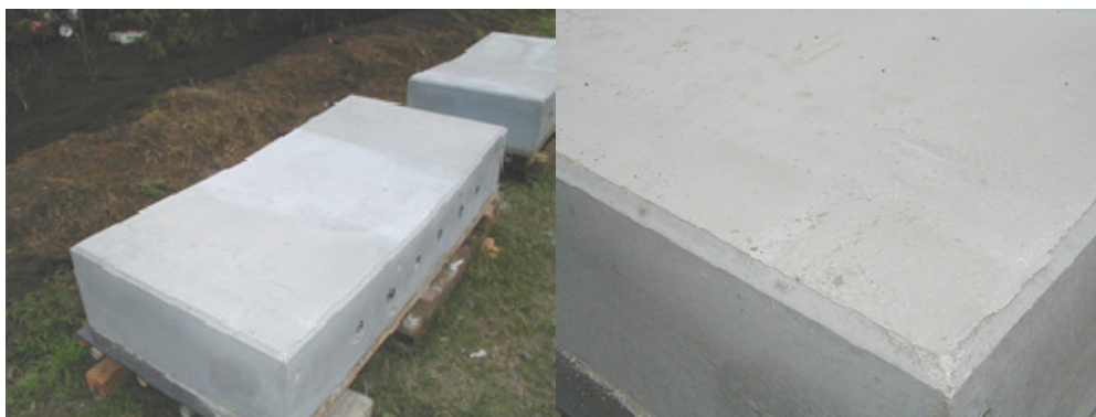
写真-4.2.5 部分供試体②の仕上げ面
