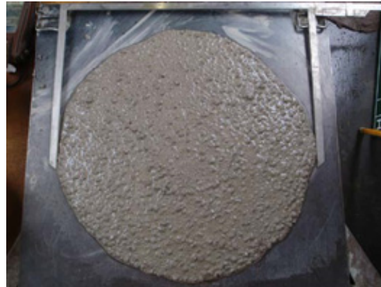
写真-6.2.11 スランプフロー試験におけるコンクリートの性状
