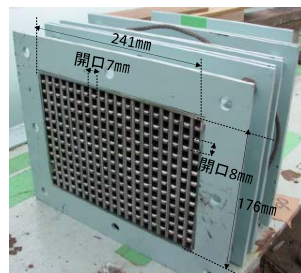
図-5.5.3 サイレンサの実験模型（上段：模型実験の形状，下段：模型の外観写真）
