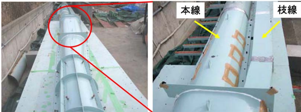
図-2.3.12 分岐部の模型外観（左図）およびその拡大図（右図）
