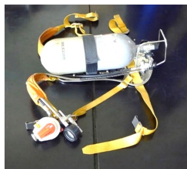
図 2.8 空気呼吸器用ボンベと背負具 (空気ボンベを取り外した背負具に呼吸代謝測定装置を固定)
