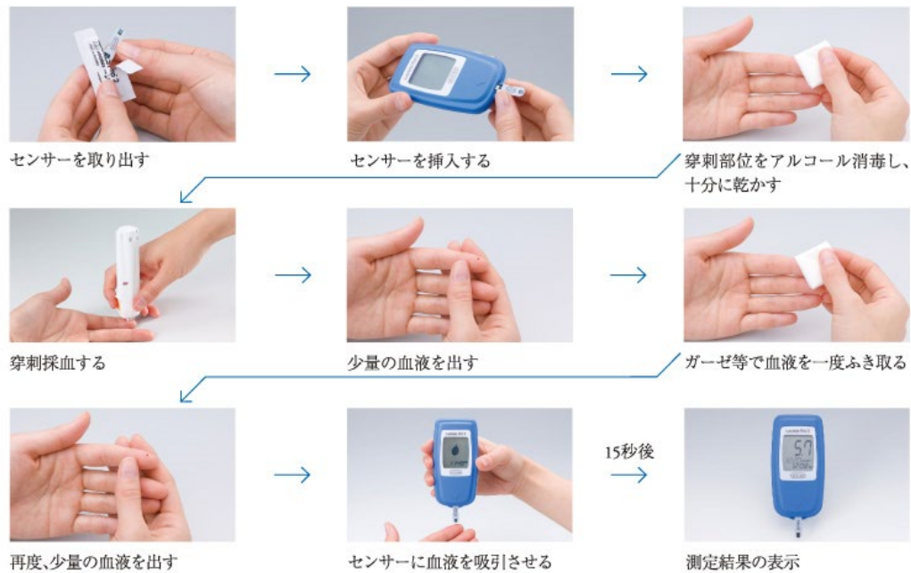
図 2.22 簡易血中乳酸測定器計測手順
