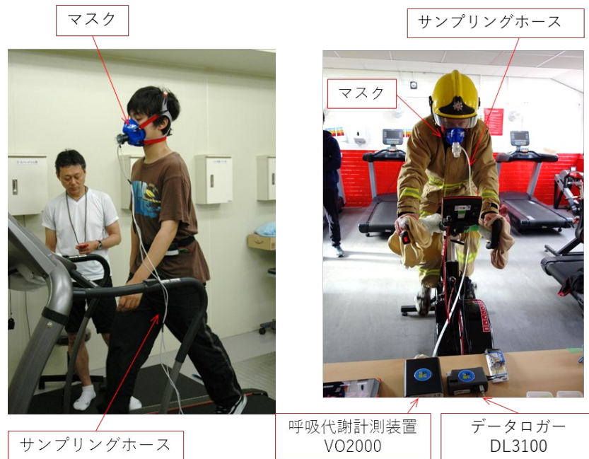
図 2.20 呼気ガス計測システム系統図
