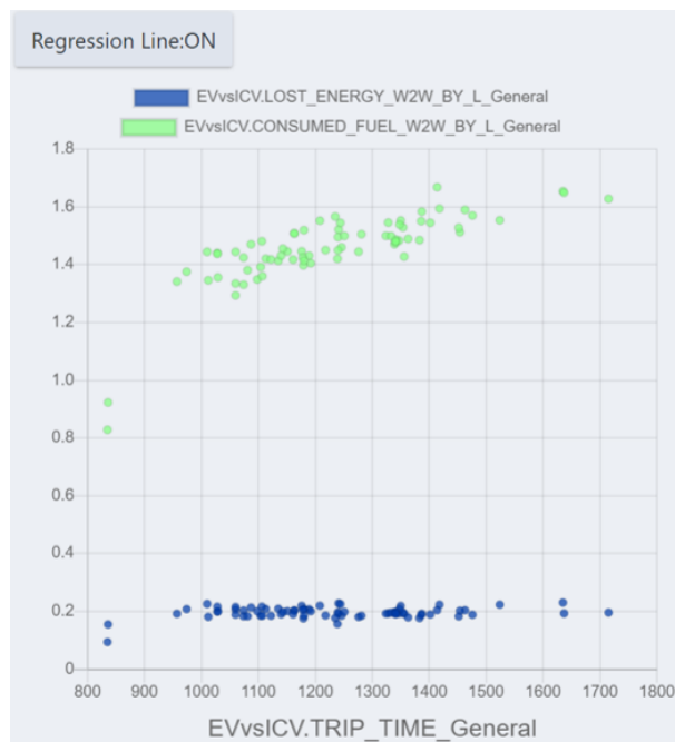
図 5.7: 解析例 1:一般道路区間の EV とガソリン車の消費エネルギー比較
